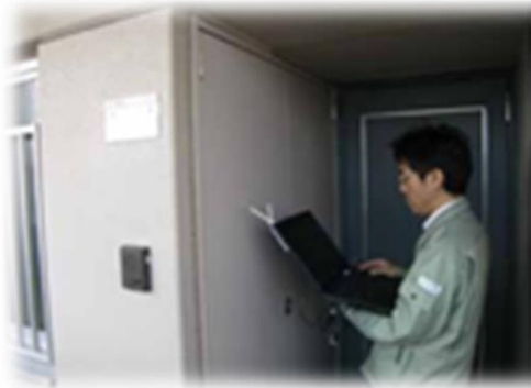
WiMAX testing in an actual meter box
